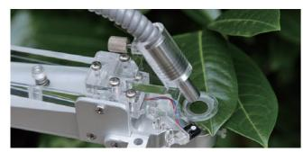
光适应叶夹, 可测量温度、光强
